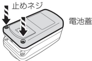
電池蓋のクリップ側を斜めに少し上げて電池蓋のツメをはずし、蓋を開きます。
