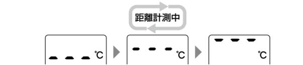
※距離測定中に測定ボタンを押すと、測定は中止されます。
