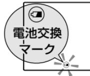
電池交換マークが表示されたら 4 本の電池全てを新しい電池と交換してください。電池は同じ種類のものを使用してください。種類の違う電池や古い電池と新しい電池を混ぜて使用しないでください。
