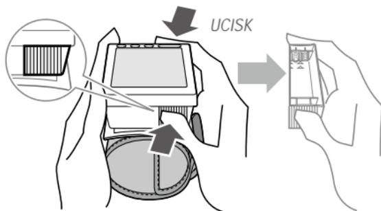
Włóż dwie baterie alkaliczne AAA (LR03) tego samego typu i o równym poziomie zużycia.
