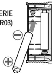
Symbol baterii [
